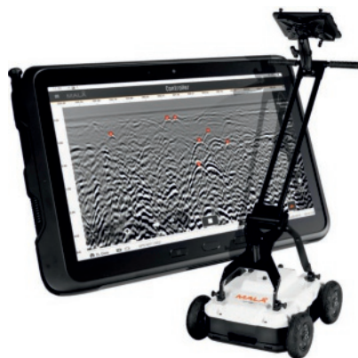
MALÅ Easy Locator Core upptäcker infrastruktur under marken med radar.
