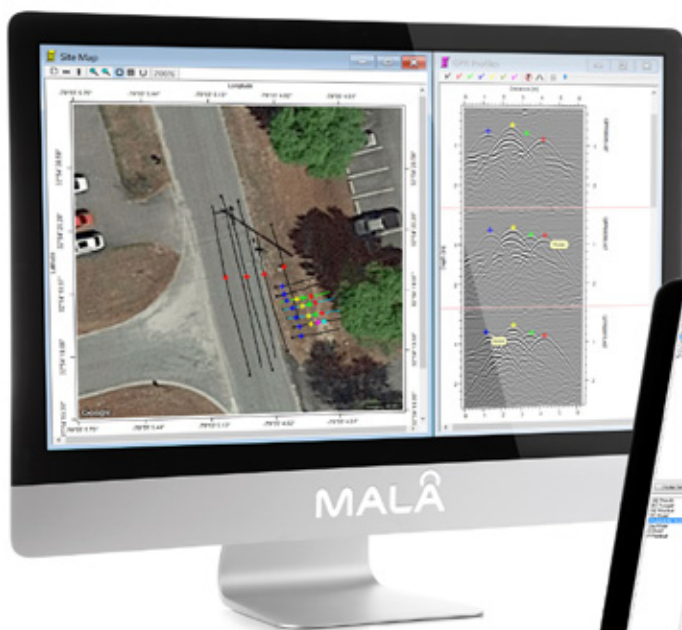
MALÅ Object Mapper 2018 visualiseringsmjukvara, med internetbaserat kartstöd (Google Maps), utvecklad för kartläggning av infrastruktur under mark.
