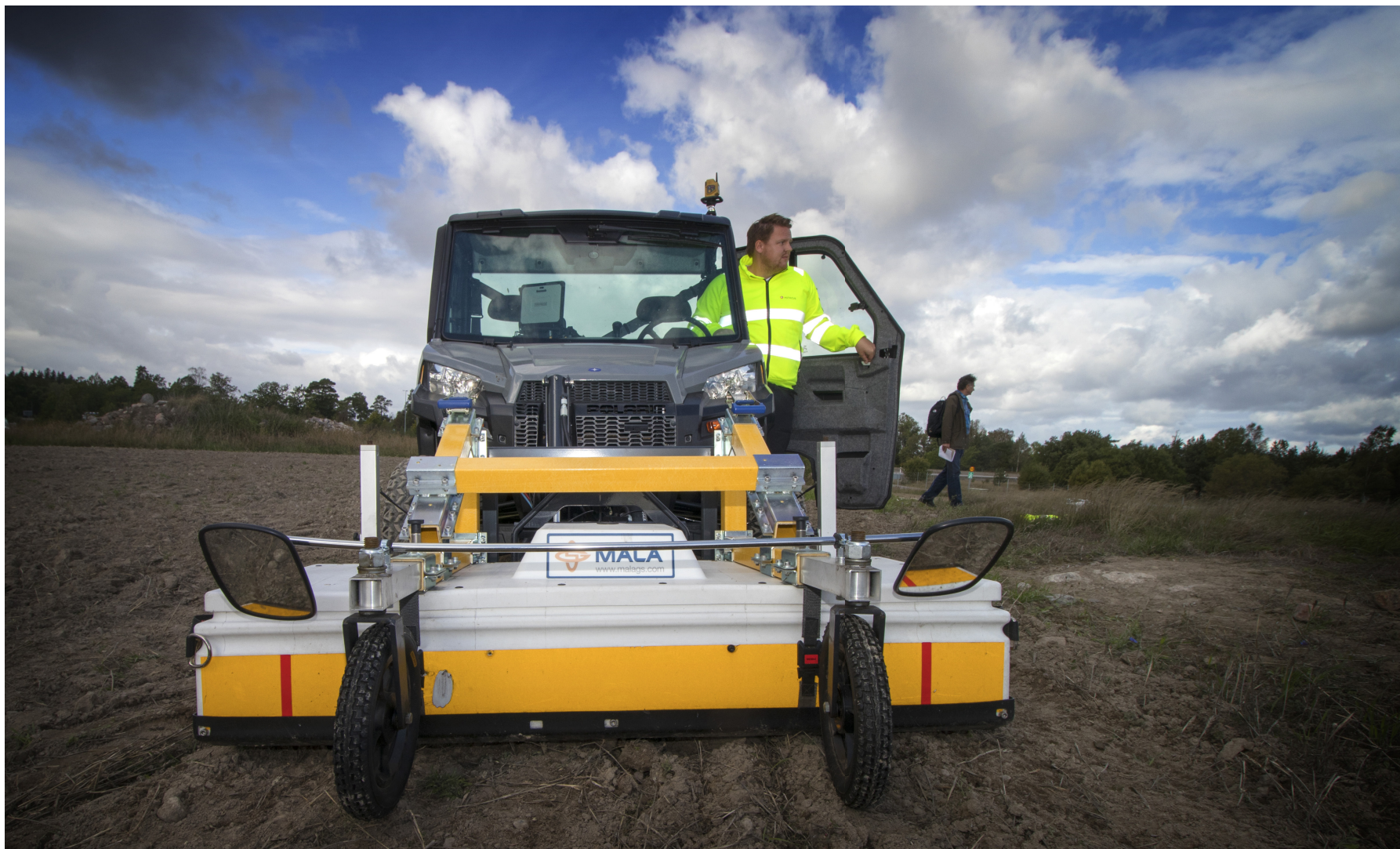
Georadar är en teknik för att hitta infrastrukturer under marken. Carl Hoffstedt opererar maskinen.
